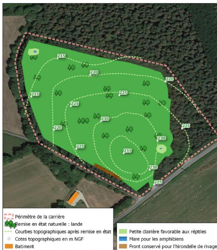
Schéma de principe de remise en état du site. Source : dossier, chapitre 8 p.104)
